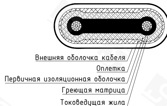
Вид А. Саморегулирующийся кабель. М 2:1
